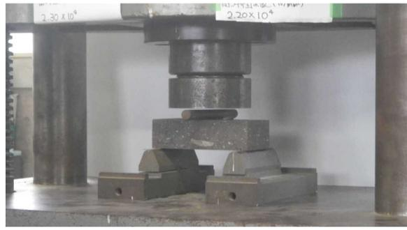
図2 曲げ試験状況
