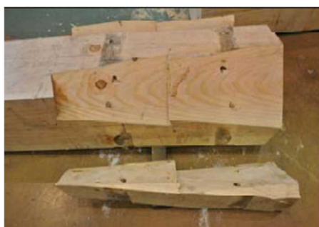
破損状況 (鋼板バンド CMHN-3)
