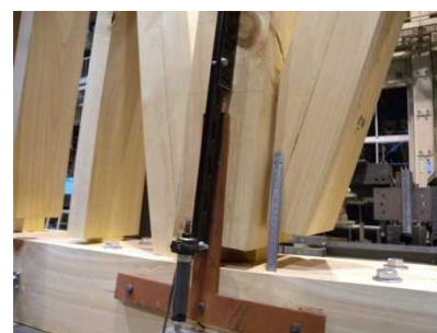
試験体 IA-1 最終変形状況 筋違の面外変形、柱脚金物の浮き上がり
