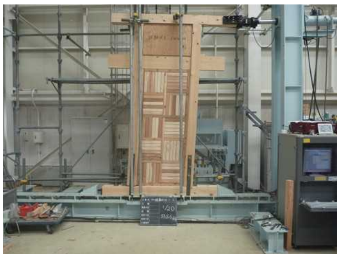
試験体⑤の最終加力状態と破損状況の確認
