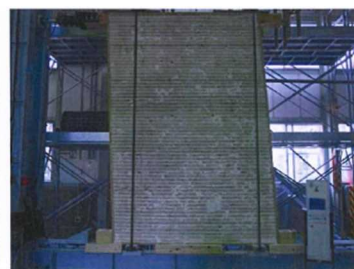
漆喰の脱落（木摺漆喰-3）
