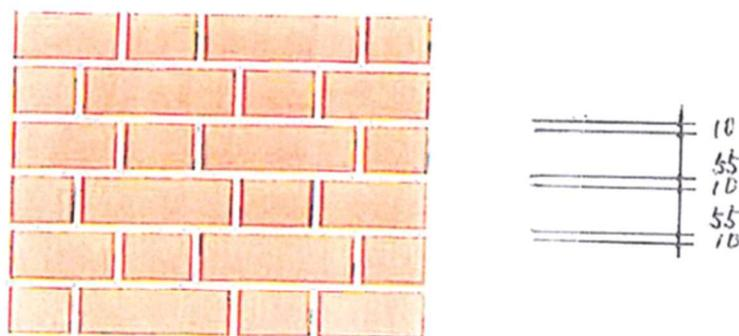
図 8-5 煉瓦と目地の寸法構成
