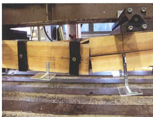
金輪継+鋼製バンド (KJS-X1)
