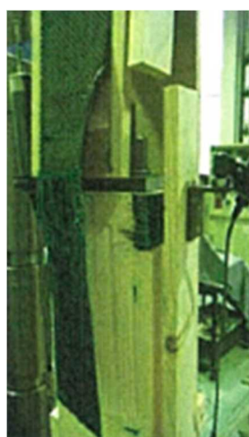
⑦CCT-CS-4 接着面 木理破断と剥離防止 シートの破断
