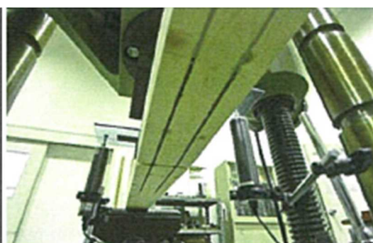
③CCB-Li25-2 接着面 木理破断か接着剤剥離か判定できず
