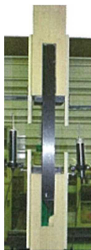
①CCT-N20-1 引張破断状況
