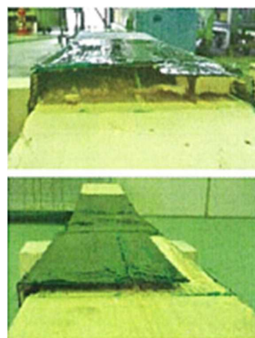
⑨CCT-CS-6 接着面 木理破断、剥離防止シート は破断せず
