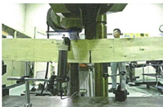
③CCB-Li25-2 曲げ破損状況
