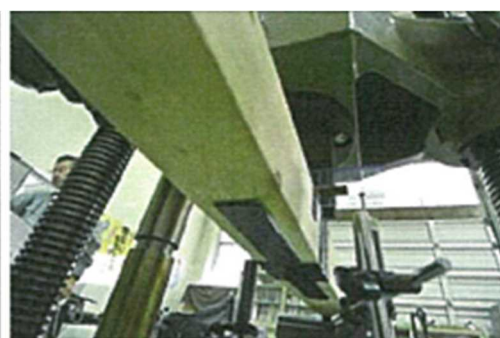
①CCB-Ls25-2 接着面 木理破断
