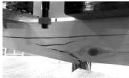
写真7 加力点直下の曲げ破壊
