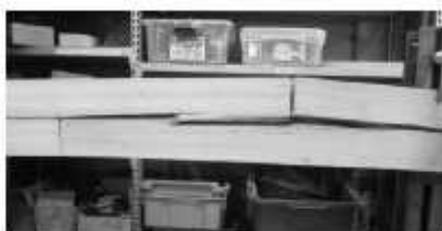
写真2 金輪継破壊の様子 (K4-1)
