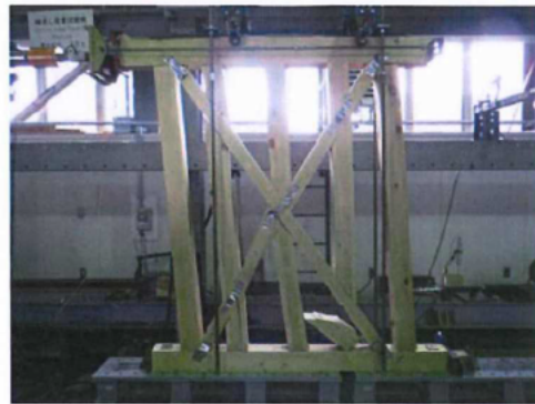
写真 試験終了後の様子(No.2_B) 全体の様子(変形角 1/20rad)
