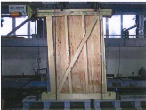
写真 試験終了後の様子(No.3_A) 全体の様子(変形角 1/17rad)
