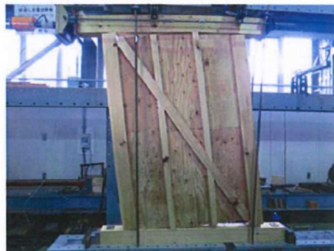
写真 試験終了後の様子(No.3_B) 全体の様子(変形角 1/15rad)
