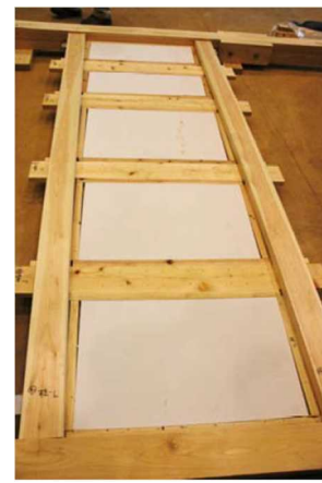
試験体④：耐力面材の 木枠へのめり込み
