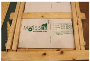
試験体③：耐力面材の 柱へのめり込み
