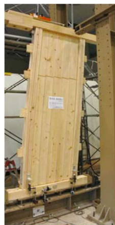
試験体④：最終 引張状況
