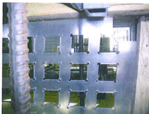
穴の変形状況
