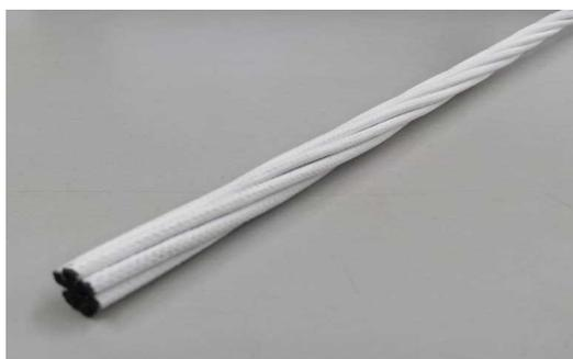
炭素繊維より線 (CFRTP より線)
