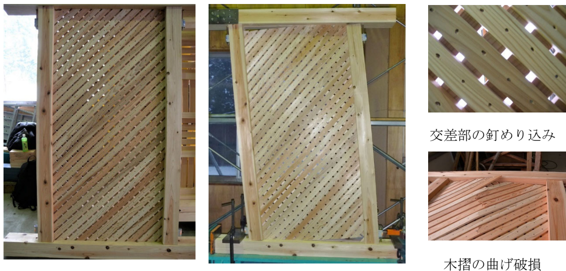
写真 2 層間変形角 1/100、1/30 を超えた合板耐力壁の変形状況
