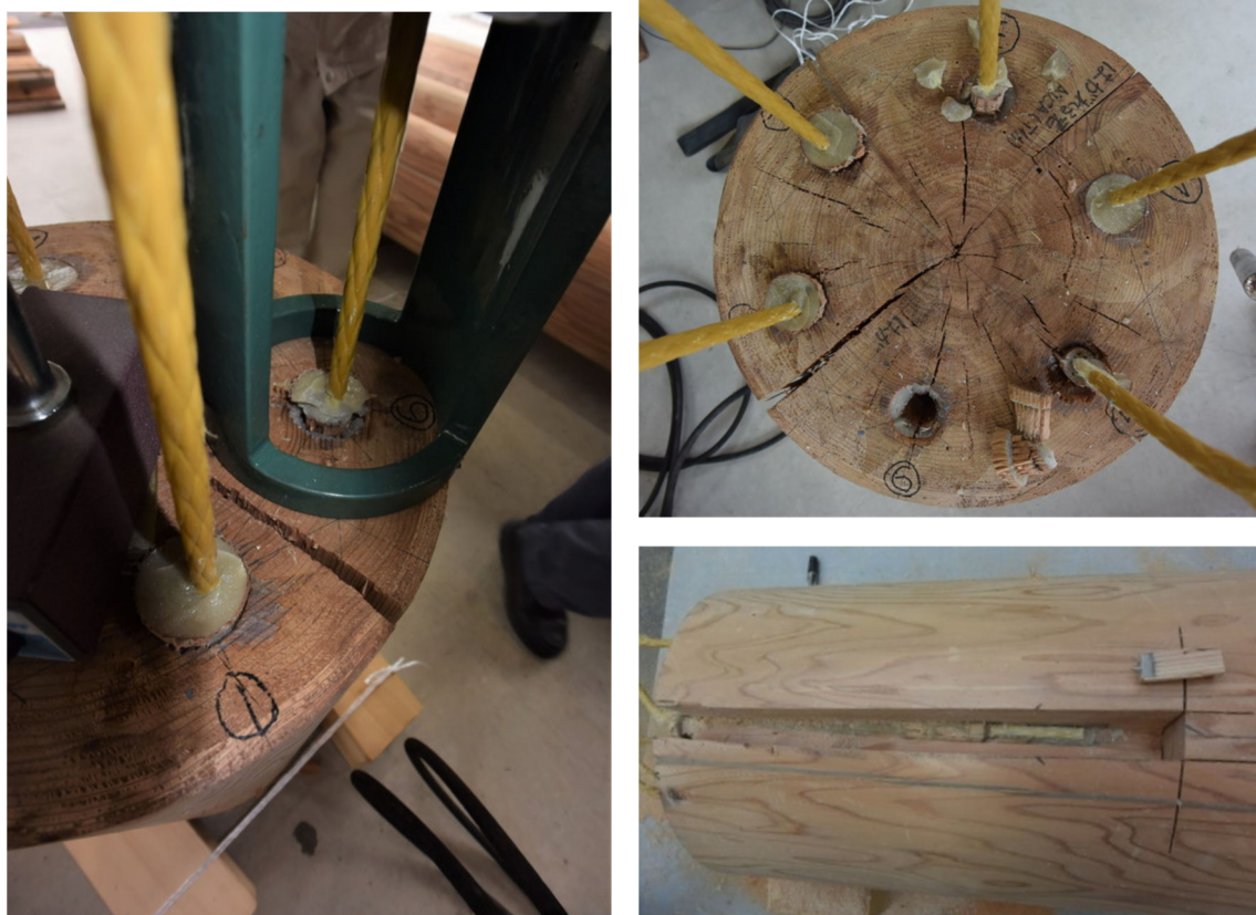
写真6 引抜試験の破損状況
