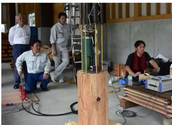
写真4 ロッドの引抜試験
