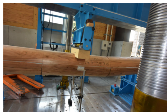
写真12 除荷後の試験体の状況
