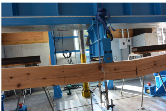
写真8 除荷後の梁の変形
