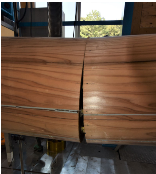
写真10 継手部の破損状況
