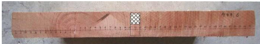
写真 2 小試験片の採取
