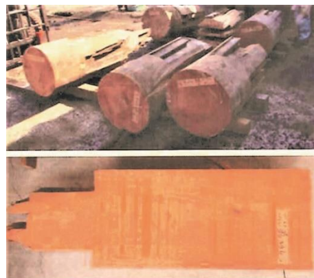
写真1 破棄された柱頭部と板材の採取
