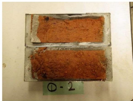
目地引張強度供試体の破壊状況
