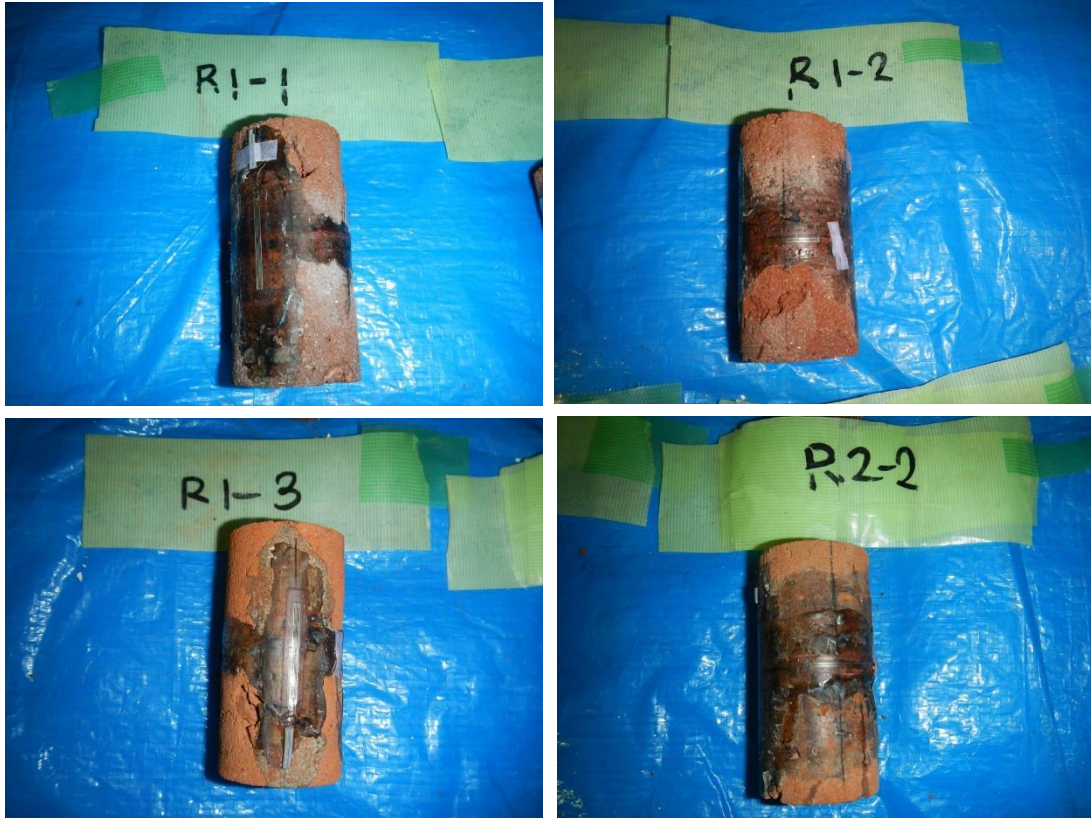
煉瓦単体の圧縮強度・静弾性係数・ポアソン比測定供試体の破壊状況
