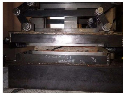
目地せん断強度供試体の破壊状況
