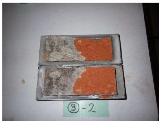
目地せん断強度供試体の破壊状況
