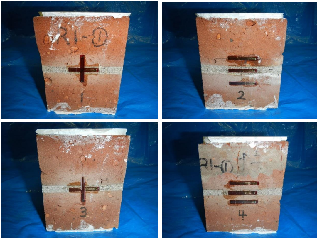
煉瓦要素供試体の破壊状況 R1-①
