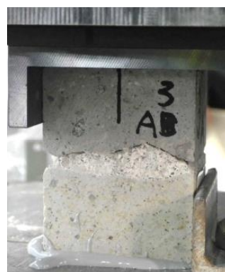
No.6 石材+目地 せん断強度試験 ( 40 \times 40 \times 50 )
