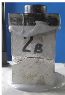
No.4 石材+目地 引張強度試験 ( 40 \times 40 \times 50 )
