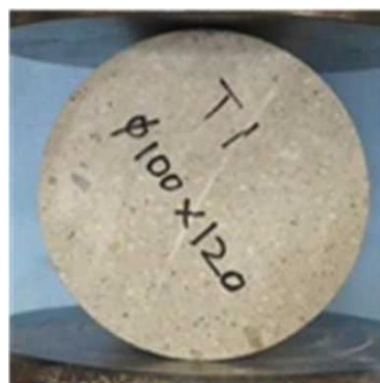
No.3 石材単体 割裂引張強度試験 ( \phi 100 \times 120 )
