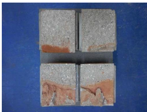
No.10 【煉瓦要素 引張強度試験】
