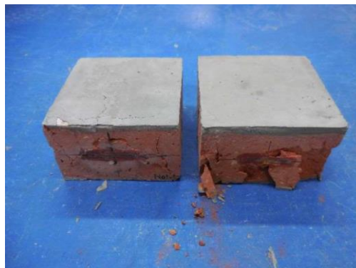
No.7 【煉瓦単体 引張強度試験】
