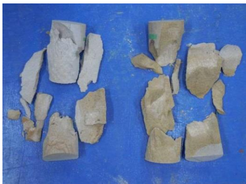
No.2 【石材圧縮強度試験】
