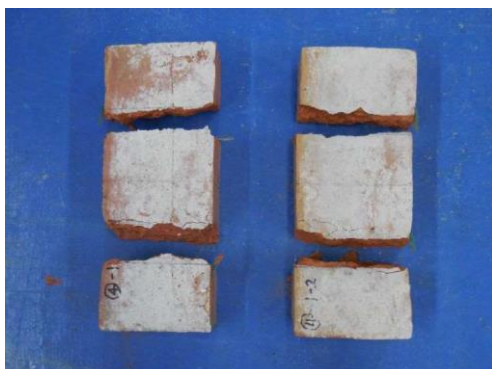
No.8 【煉瓦単体 せん断強度試験】
