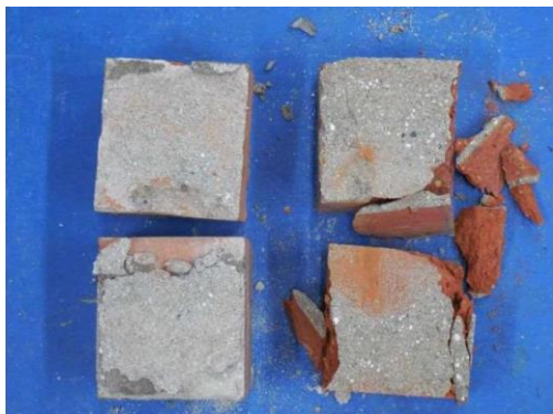
No.9 【煉瓦要素 圧縮強度試験】
