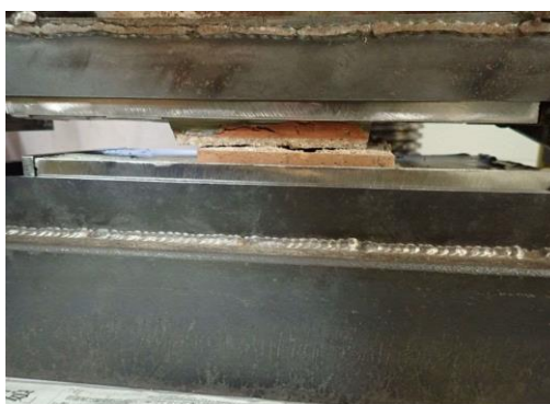
No.11 【煉瓦要素 せん断強度試験】
