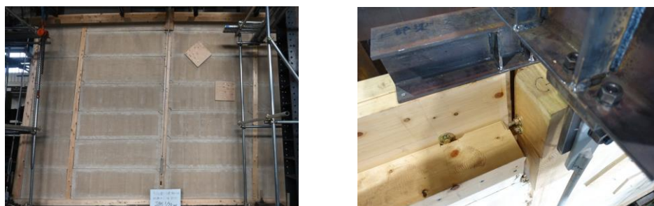
写真 5 試験体 (試験体 5/C-1b) /左：面内座屈補剛状況/右：上部梁継手部の破壊
