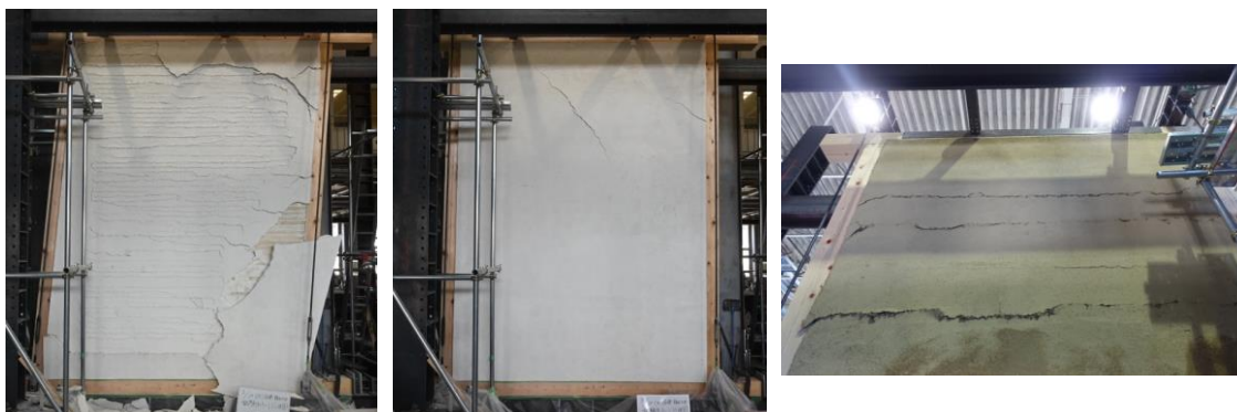
写真 1 破壊の様子 (試験体 1/A-1) / 左: 終局時 / 中央: 1/75rad 時 / 右: 1/30rad 時
