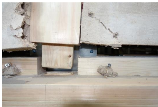
写真 6 破壊の様子 (試験体 6/C-2) / 左: 終局時 / 右: 1/15rad 時中央柱脚浮上り
