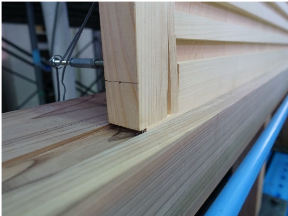
縦框の割裂破壊 (M 試験体)
