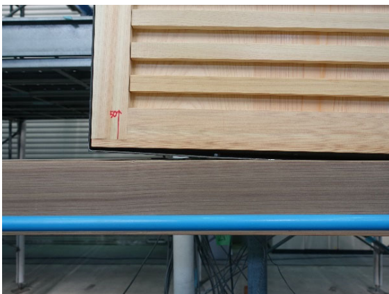
アングル鋼枠の浮き上がり (RM 試験体)
