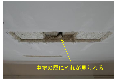
試験体 2（中塗りで剥離後、中塗面にて再試験した後の様子）
