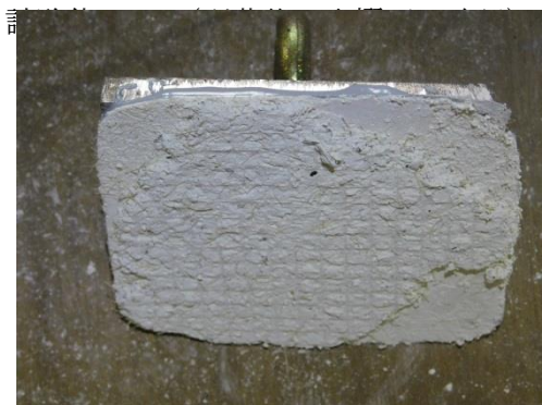
試験体 A2-1 (剥落後鉄板側)
