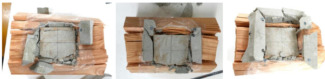
写真5 破損状況：天端めり込み
