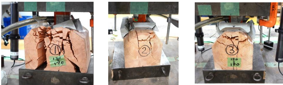
写真 4 各試験体の破損状況：木口面
