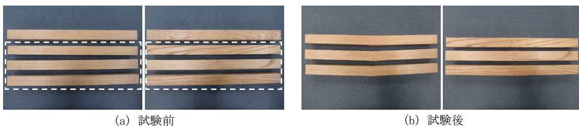
写真 13 試験体状況_A-曲げ
