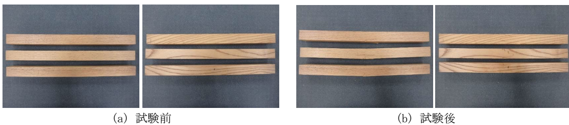
写真 14 試験体状況_B-曲げ
