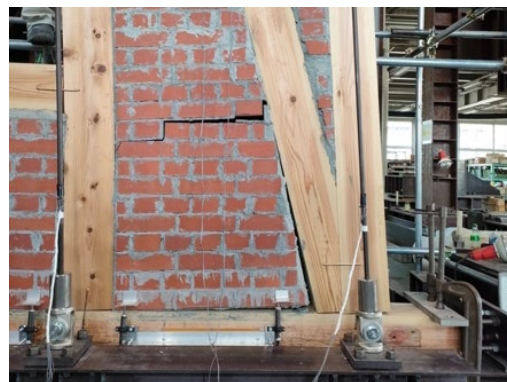
1-WBV 試験体 脚部ひび割れ状況
