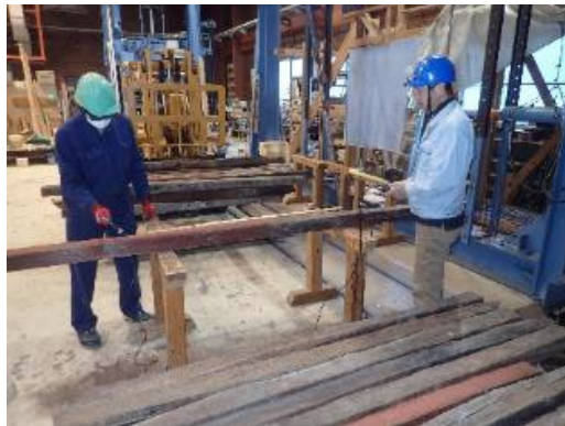
写真4 FAKOP によるヤング係数の測定
