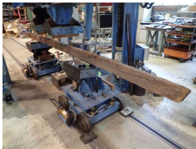
写真 5 実大曲げ試験
