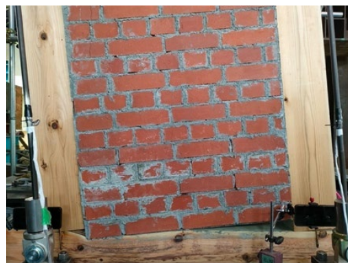
1-B 試験体 脚部 煉瓦めり込み状況
