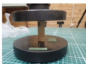
写真 8 小試験体 圧縮試験
