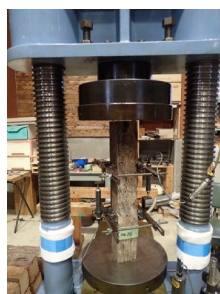
写真 6 実大圧縮試験
