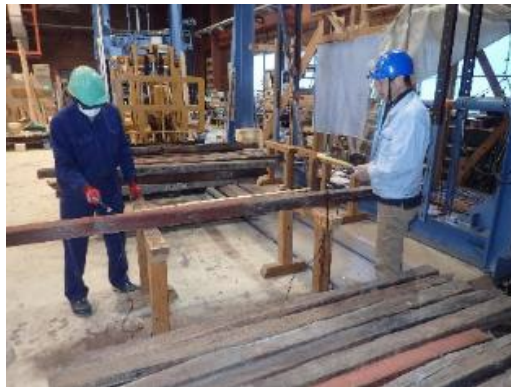
写真4 FAKOP によるヤング係数の測定
