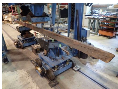
写真 5 実大曲げ試験
