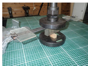
写真 9 小試験体 部分圧縮試験
