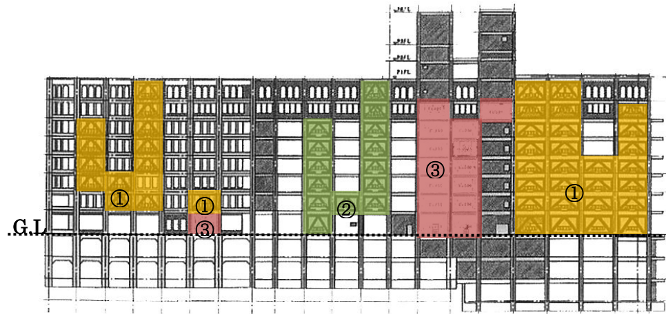
補強位置（a-a' 断面）＊
