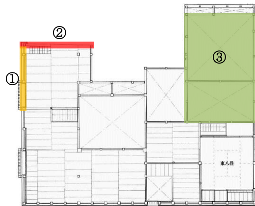
補強位置（二階平面）＊
