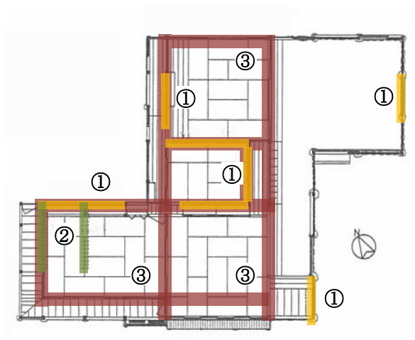
補強位置（一階平面）＊
