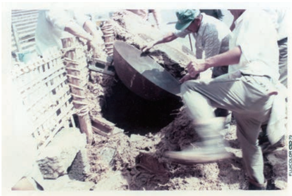
写真 122 唐釜製造工程⑬
