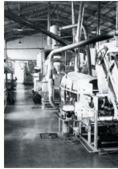
写真 165 高性能炒葉装置 高性能ニューセラミックス炒葉機（手前） 高性能連続葉振り機 特許出願中、平成 9 年開発
