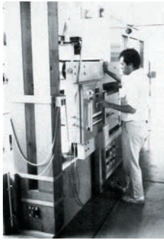
写真 164 マイクロ波加熱による荒茶乾燥装置 平成 3～4 年 九州電力 KK、新日本無線 KK との共同開発
