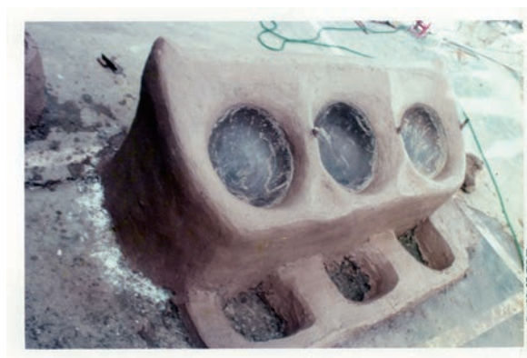
写真 131 唐釜製造工程㉖
