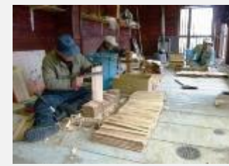
住民による木羽へぎ作業
