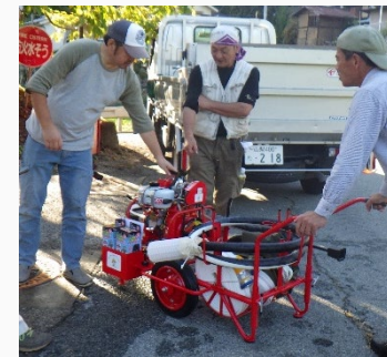
消防用ポンプ
