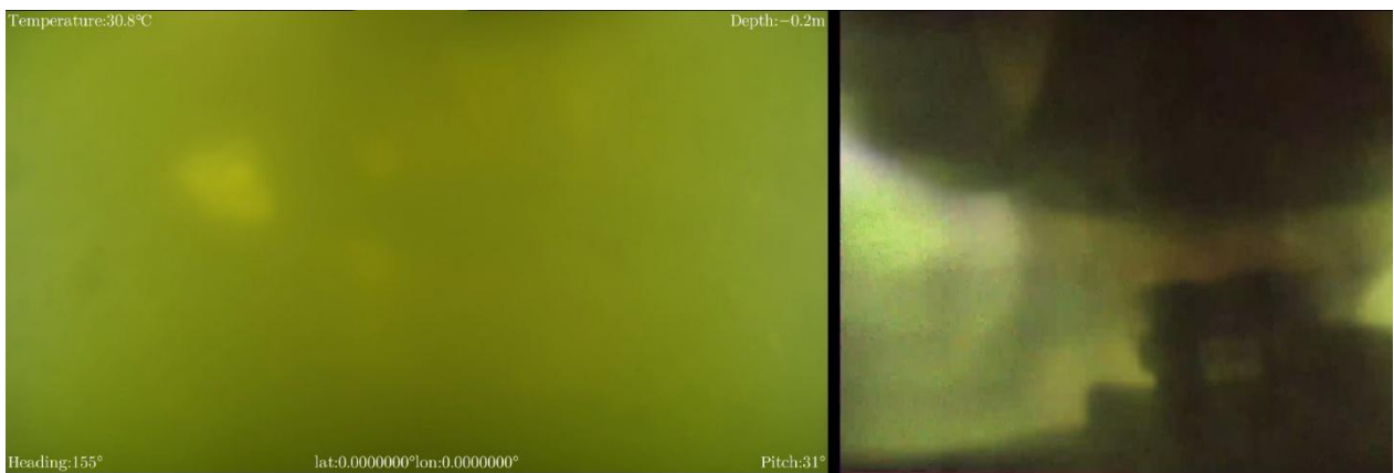
図 2-20 水深 20 cmにおける通常カメラの映像（左）と濁水カメラの映像（右）
