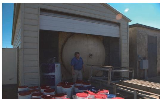
テキサス A&M 大学保存処理ラボ 大型凍結乾燥機
