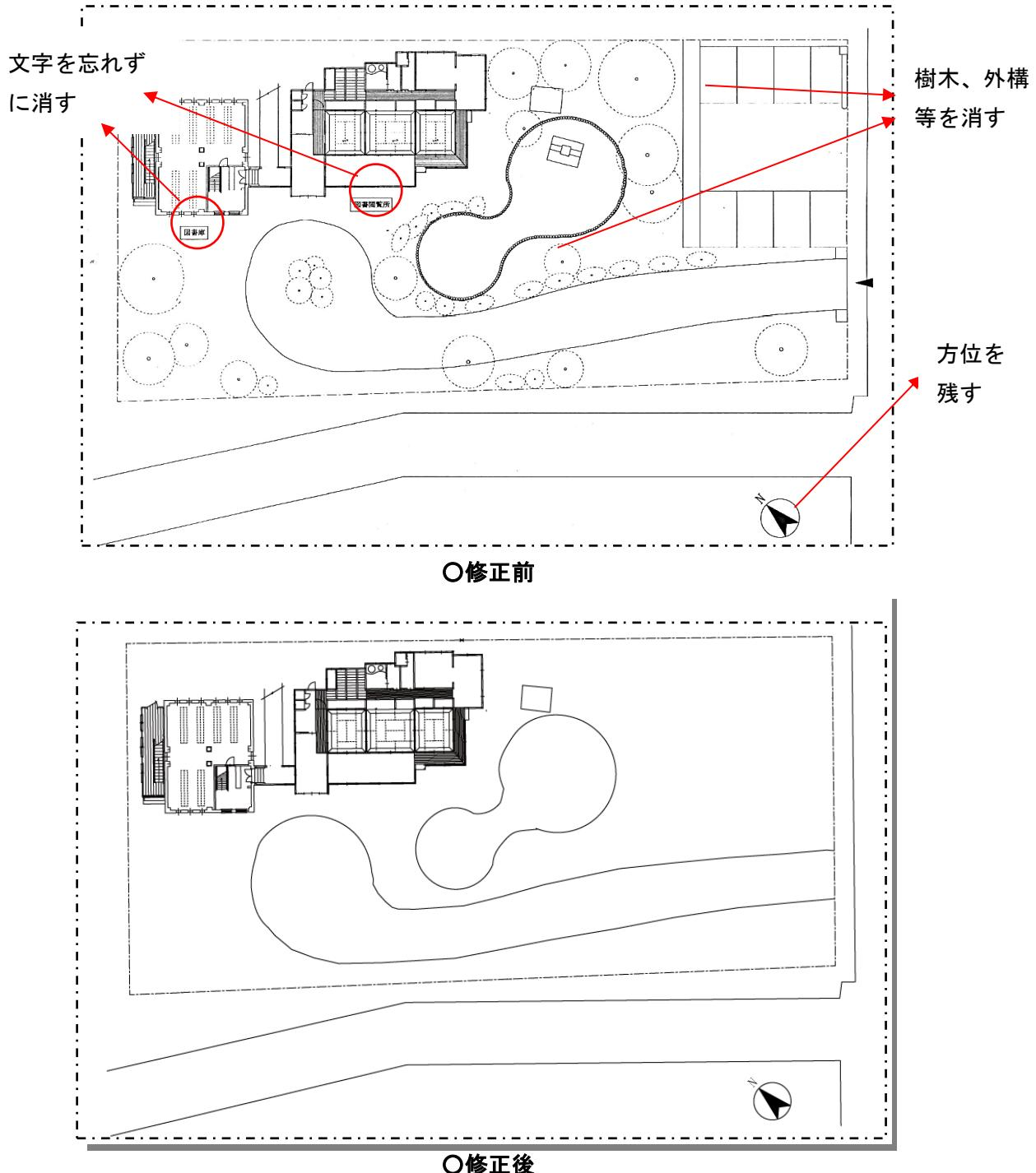
図 1-4 配置図(データ送付用)の作成例
