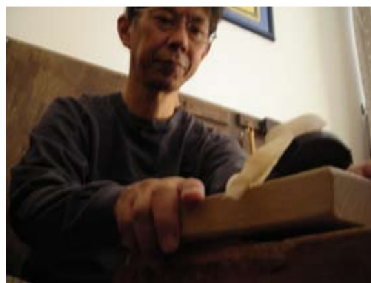
漆刷毛の仕上げ作業
