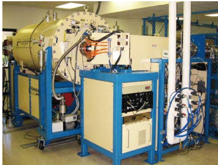
図5 放射性炭素年代測定のための加速器質量分析(AMS)装置(写真提供:Center for Applied Isotope Studies, The University of Georgia)
