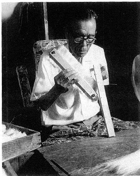
馬毛を材料とした刷毛づくり作業
