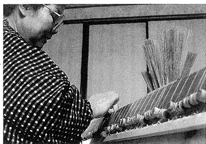
竹片子による簀簾編み作業
