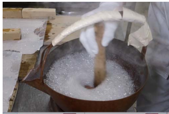
【攪拌-1】攪拌を開始する。予熱で沸騰状態が続く。攪拌は休まず続ける。
