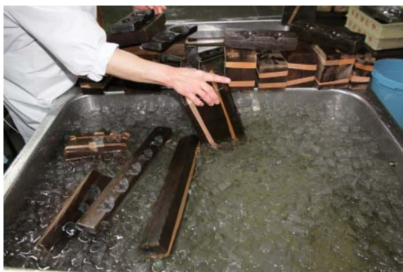
【おこし-23】木型は砂糖の残りを取り除き、ゴムバンドで止めて氷水に浸けておく。
