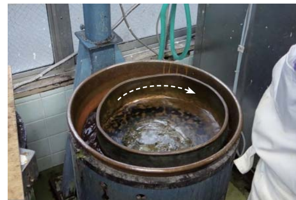
【飴作り-2】銅鍋は水に浮かし、回す事で早く冷える。
