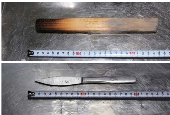
（上）ヘラ 糖液の煮詰めから攪拌に用いる。（下）ナイフ バリ取り等に用いる洋食用のもの。
