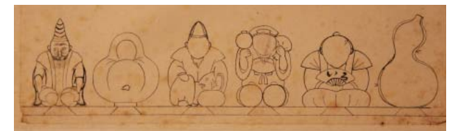
福德煎餅の金花糖の木型 下の写真は前述の「加賀らくがん木型雛形」であり、同じ図柄が描かれている。糖液の流し込み口も描かれている。（落雁 諸江屋蔵）
