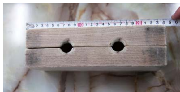
桃とパイナップルの木型の注ぎ口 いずれの注ぎ口も漏斗状に広がり、流し込みやすくなっている。
