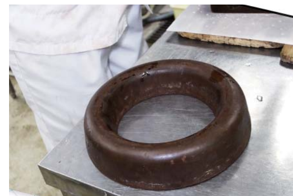
攪拌時の台座 鉄製で重く、激しく攪拌してもずれない。
