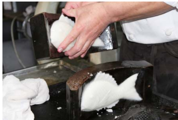
【2連の木型-5】糖液を注いでから5分後に木型を外して2匹の鯉を取り出す。
