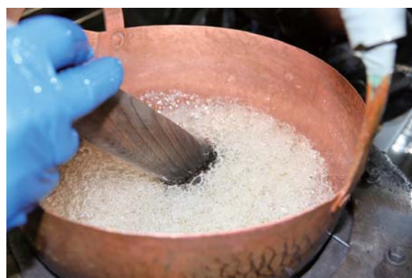
【煮詰め工程-3】強火で焚き始めておよそ10分で、泡に粘性が出て盛り上がり、液面が見えなくなる。
