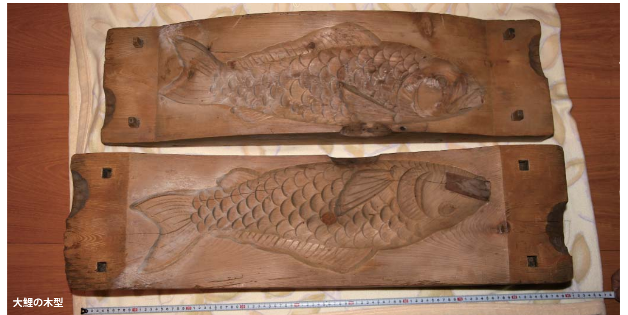
大鯛の木型 凹側の木型が3分割され、丁番で接続し、順に開いて金花糖を取り出す仕組み。（落雁 諸江屋蔵）
