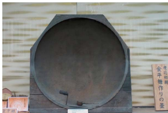
金平糖初代製造釜（江戸時代末期） 直径820mm × 深さ250mm。 （写真提供：緑寿庵清水）
