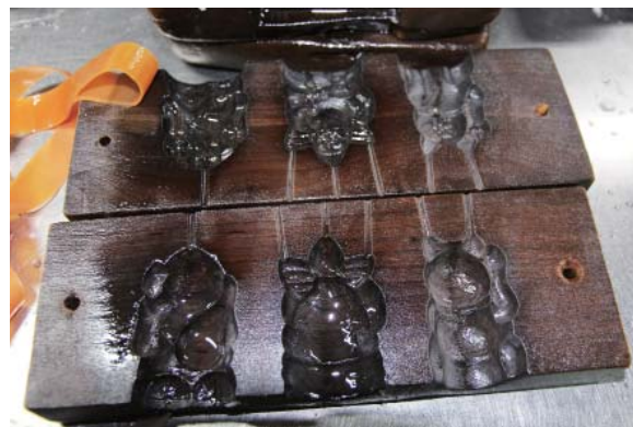
（左から）大黒様、恵比寿様、招き猫の木型 空気抜きの筋が彫られている。他の木型には空気抜きは見られなかった。
