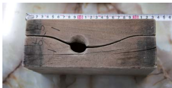
鯛の木型の腹側と注ぎ口 独特の湾曲線が繋ぎ目に現れている。
