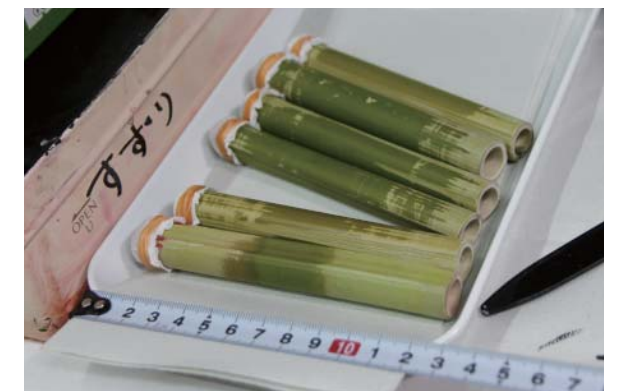
吹き付け用の竹筒 長さ13cmほどで、内径は10mm前後の肉薄の竹である。
