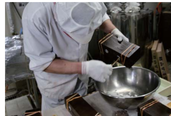
【流し込み-5】注ぎ口回りのテーパ部分の結晶を竹箸でくずしておく。
