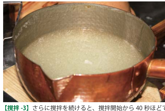
【攪拌-3】さらに攪拌を続けると、攪拌開始から40秒ほどで白濁し始め、わずかに液面が膨らむ。55秒で流し込みに移る。
