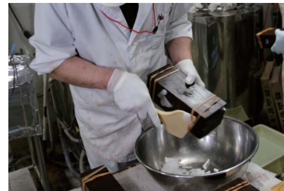
【流し込み-4】注ぎ口の回りの結晶を樹脂のへらで削ぎ落とす。
