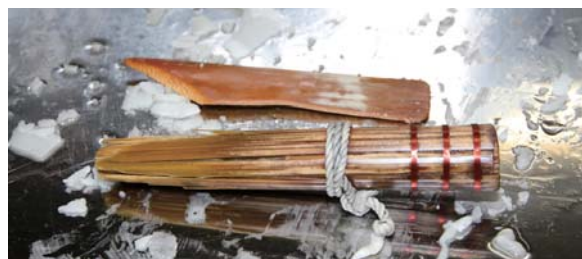
ササ（17cm）と竹べら（14cm） 砂糖を煮詰める時、銅鍋の内側に付着する砂糖の結晶をかき落とす。
