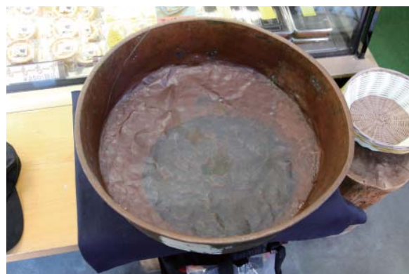
銅鍋＝ドラ 多めの糖液を冷ます時に使用する。
