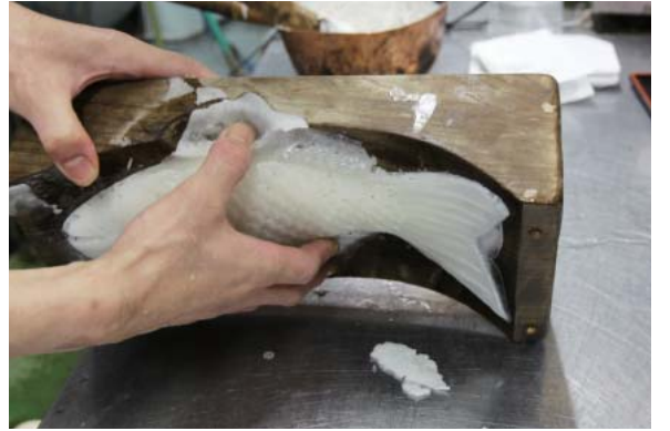
【流し込み -5】 鯛の本体を、流し込み口に指を掛けて、慎重に木型から取り外す。
