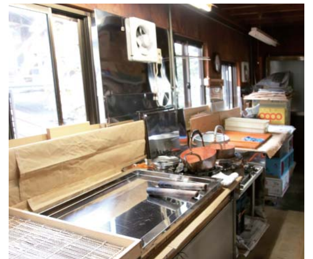
金花糖の作業場 奥からガスコンロ（火床）攪拌場所、流し込みの場所、製品置場（すだれ敷）になっている。
