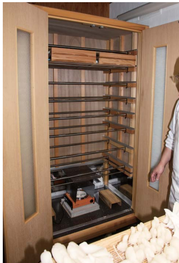
戸棚で作った乾燥庫 小型の電気ヒーターが置かれている。鉄棒の上に竹簀の箱を差し込んでいく。
