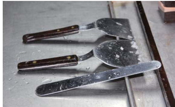
流し込み後に使用する金ベラ。幅広のヘラで、木型からはみ出した砂糖を削ぎ落とす。棒ヘラは修正用。
