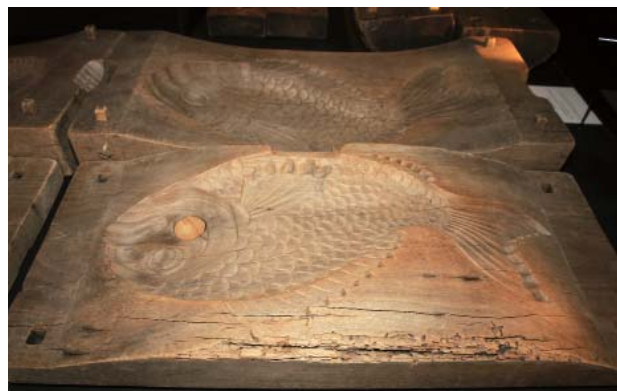
にらみ鯛木型 左右4枚の木型寸法は幅65～66cm奥行28～29cm、高さ（厚さ）凸型7～8cm、凹型10～11cmである。 〈1〉
