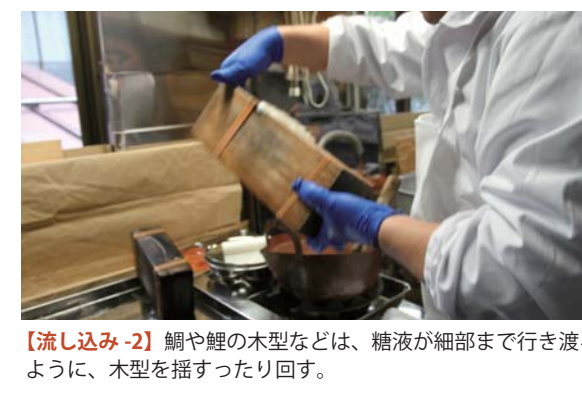
【流し込み-2】鯛や鯉の木型などは、糖液が細部まで行き渡るように、木型を揺すったり回す。
