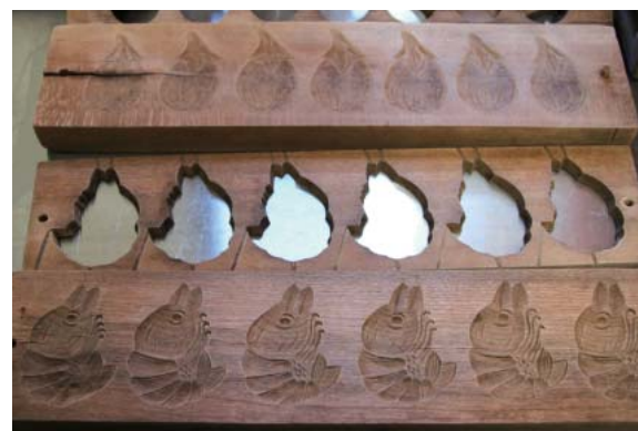
エビの木型（手前）と茄子の木型（奥） いずれも平型で、厚みを持たせるための型が加わる。
