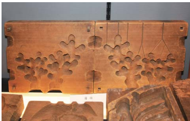
近世～明治時代の木型 珊瑚の金花糖の木型であるが、右片をよく見ると、複雑な空気抜きの溝が彫られている。
