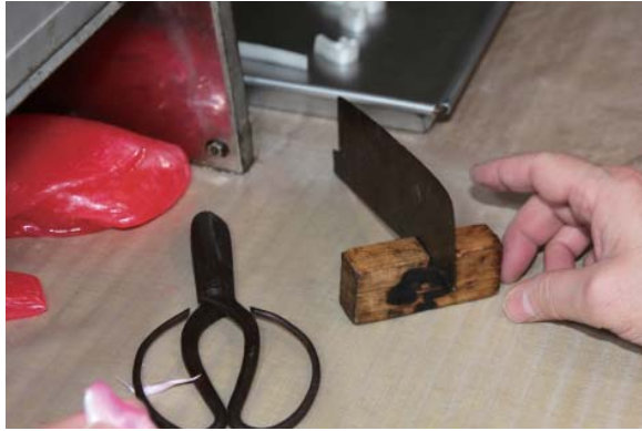
【梅-1】古包丁の刃を上に向けた状態で、木型に挟んだもの。三代目が作った道具である。
