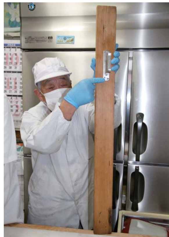
生地が多い時に使用した道具。柱に括り付けて使用する。
