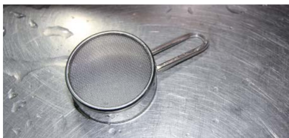
掬い網 煮立てている糖液に混入したごみを掬い取る。主に木型の破片である。
