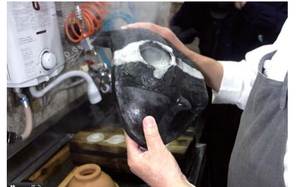
【流し込み-2】瓦型を手に持って揺すり、糖液を型の隅まで行き渡させる。
