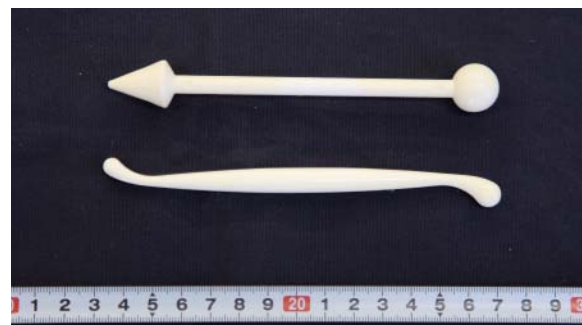
細工棒 形を整えるのに使用する。
