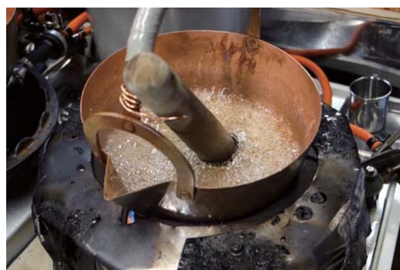
【煮詰め工程-2】およそ5分で水分が沸騰し始める。粘性の少ない泡で、沸騰している液面が見える。
