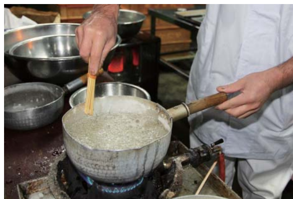
【おこし-4】着火して煮詰める。飛び散って固まる糖液をササラ（竹串を束ねて自作したもの）で削ぎ落とす。
