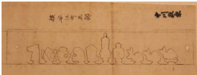
「加賀らくがん木型雛形」金花糖の図柄の割付け。流し込み口の形状も描かれている。(落雁 諸江屋蔵)
