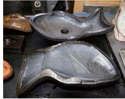
城島瓦の鯛の型 佐賀県大川市で製作された型で、全長45cm。
