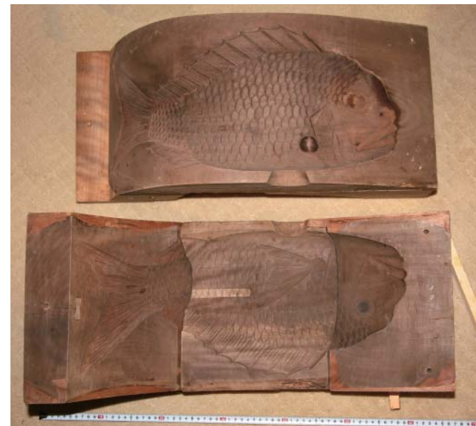
大鯛の木型 凹側の木型が3分割され、丁番で接続し、順に開いて金花糖を取り出す仕組み。（落雁 諸江屋蔵）
