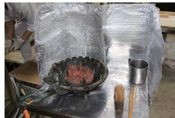
火床回りの道具 ガスコンロ、計量カップ（水入れ）、ササラ、竹べら、竹箸、後から温度計が加わる。
