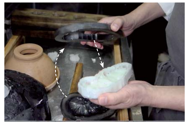
【流し込み-5】瓦の平型は外すと嵩上げ部分の型に白生地が付いているので内側（下側）に抜く。
