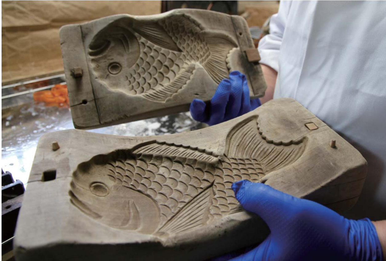
八寸（24cm）大鯛の木型 鱗の彫り、頭部とひれ先の波型、滑らかな反りなど見事な木型である。
